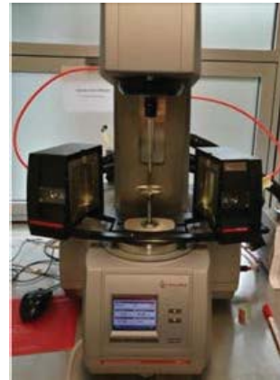
Abb. A 5.1: Versuchsaufbau, Rheometer
