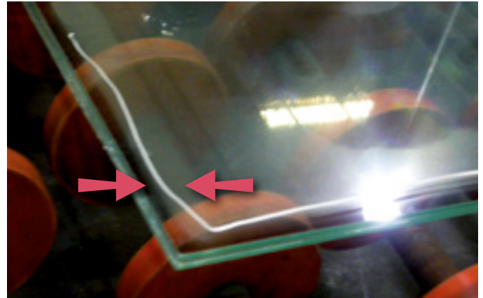
FIG 16 • Proper edge seal IR
